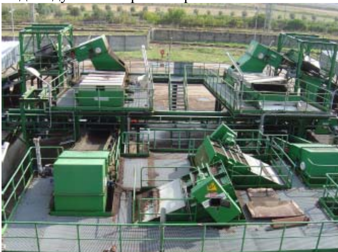
Участок подготовки и подачи древесного сырья на электростанции в Италии (60 МВт в час с дублированием).
