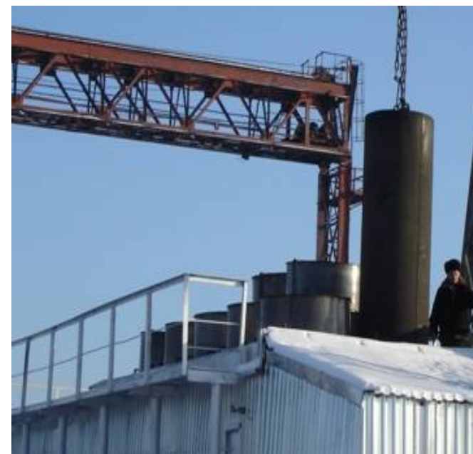
3. Реторты установлены в пиролизер
